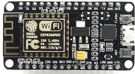
Figura 1: Foto do módulo Wi-Fi ESP8266.
